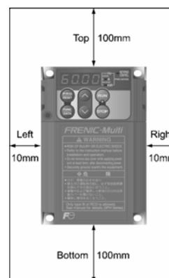
Figure 2.1 Direction de montage et distances requises
